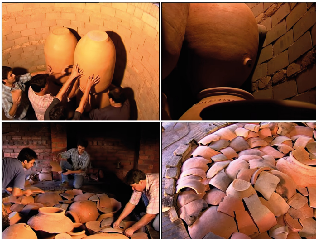
Figura 9. Carga, calzado, montaje de la cubrición y cubrición finalizada del horno del alfar tinajero de Torrejoncillo (Romero y Cabasa, 1999; fotogramas extraídos de Monesma, 1999).
